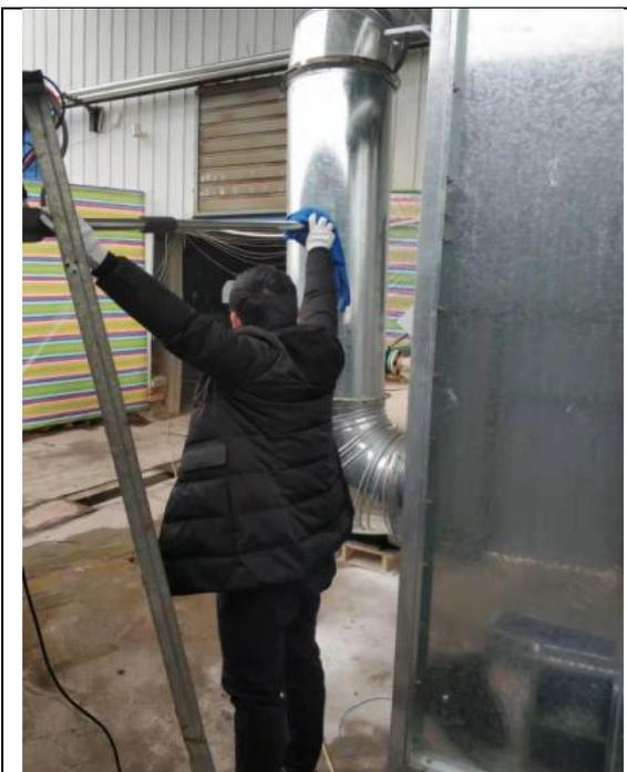
有组织废气进口监测照片
