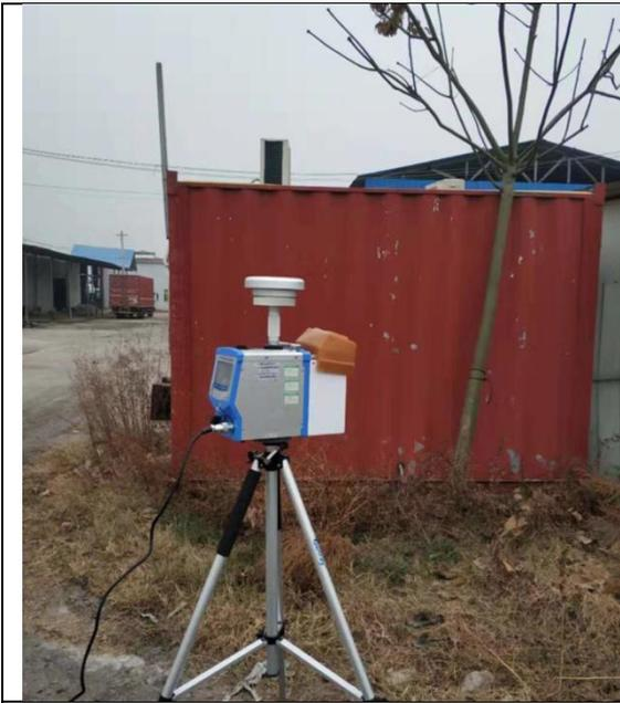
上风向无组织废气监测照片
