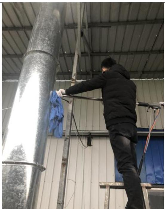
有组织废气出口监测照片
