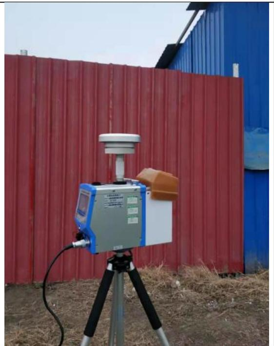
下风向无组织废气监测照片
