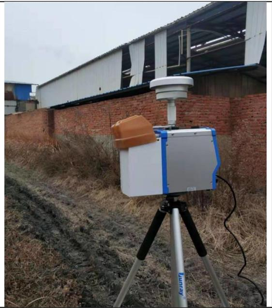
下风向无组织废气监测照片
