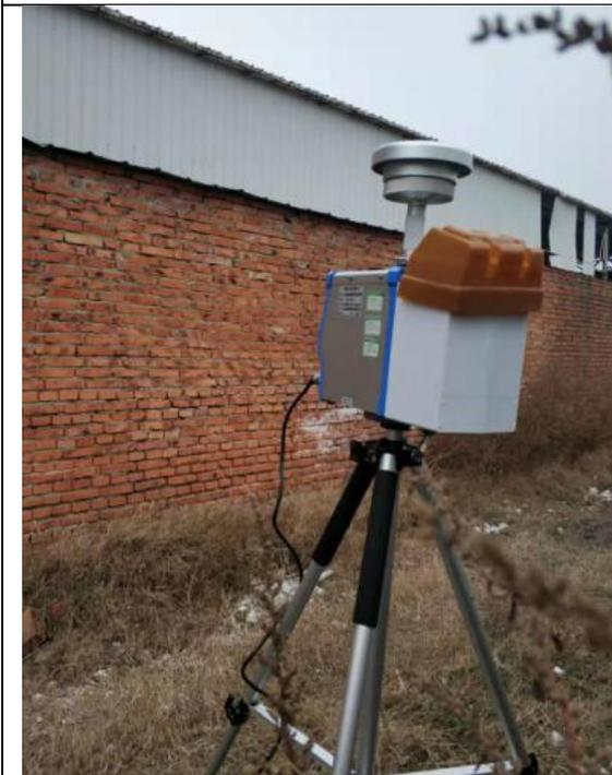
下风向无组织废气监测照片
