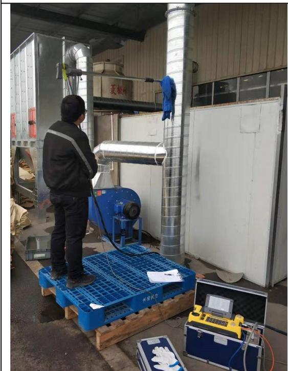
G8 破碎废气出口监测图片
