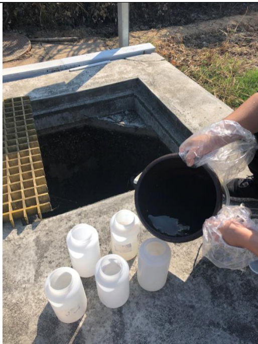
污水处理厂进口水质取样
