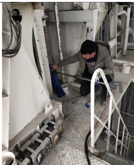
2#生产线搅拌机排气筒出口废气测点
