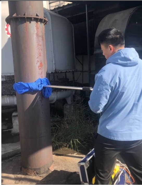
G6 有组织锅炉废气监测
