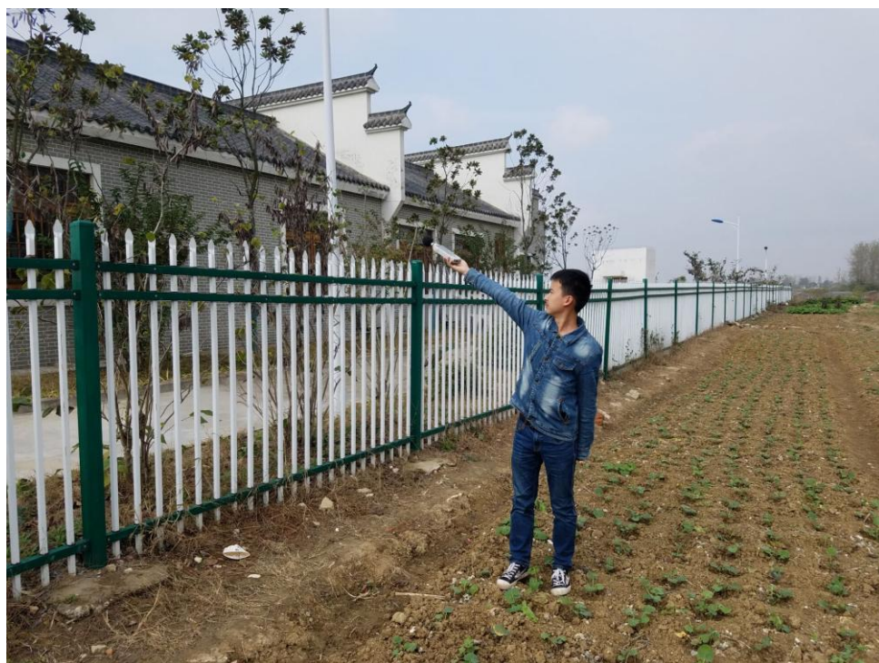
噪声现场检测
